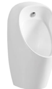
TTV206A/挂式小便器 尺寸: 400X350X745mm 颜色: 白色 冲水方式: 内置感应冲水或冲洗阀冲水 排水方式: 墙排或地排 用电方式: 直流、交流
